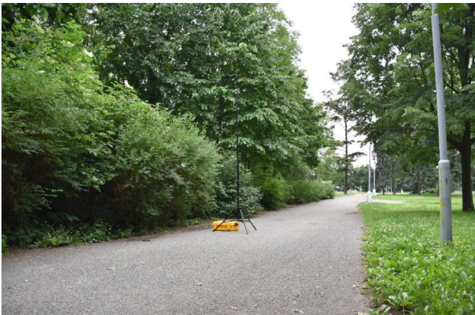
Obr. 4: Měření hluku z komunikace I/43 (ul. Sportovní, Brno), vegetační pás v termínu 17. 6. 2020. Měření provedlo Centrum dopravního výzkumu v. v. i., Brno.
