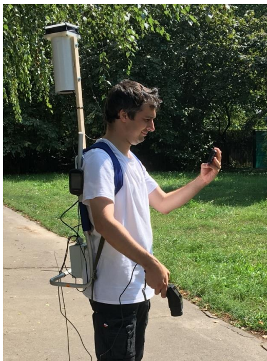
Obr.11: Měření teploty v ulicích soustavou teploměrů s GPS záznamem polohy.
